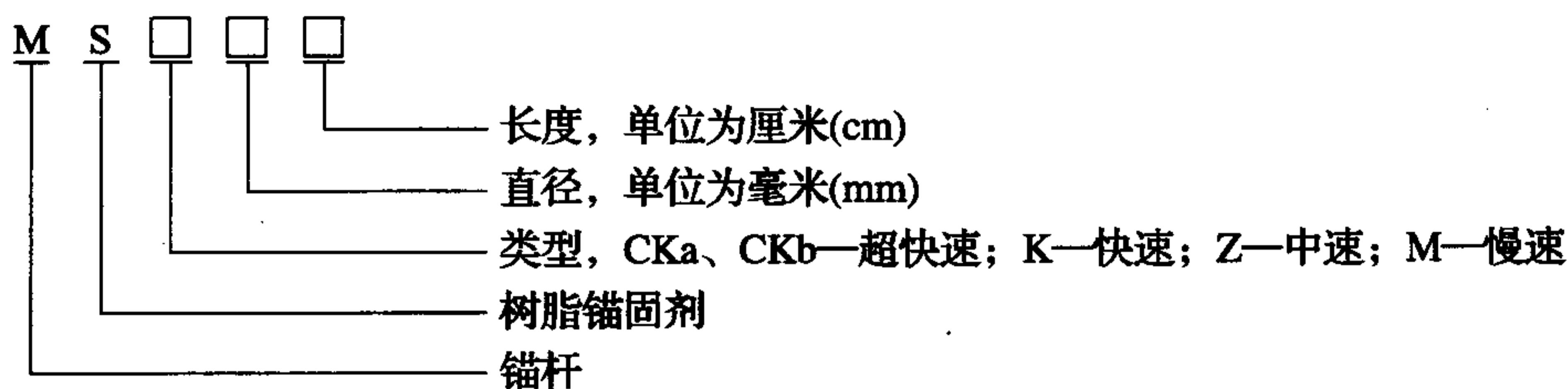
示例：直径为 23 mm、长度为 35 cm 的快速树脂锚杆锚固剂，可表示为 MSK2335。
