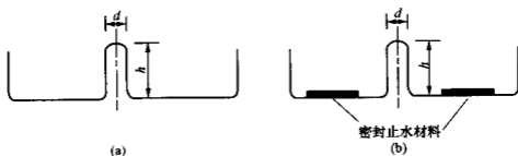
(a) W型普通金属止水带；(b) W型复合金属止水带
